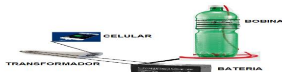
Figura 2. Desenho esquematizando o protótipo Autoria: Emanuelly Niklen Bruno Reis (2017)
